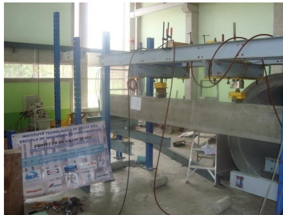
Figura 4. Aplicación de la carga a espécimen de 40cm de peralte construido de concreto (BC40).
