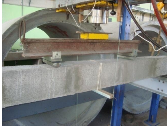
Figura 3. Aplicación de la carga a un espécimen de 20cm de peralte construido de mampostería (BM20).
